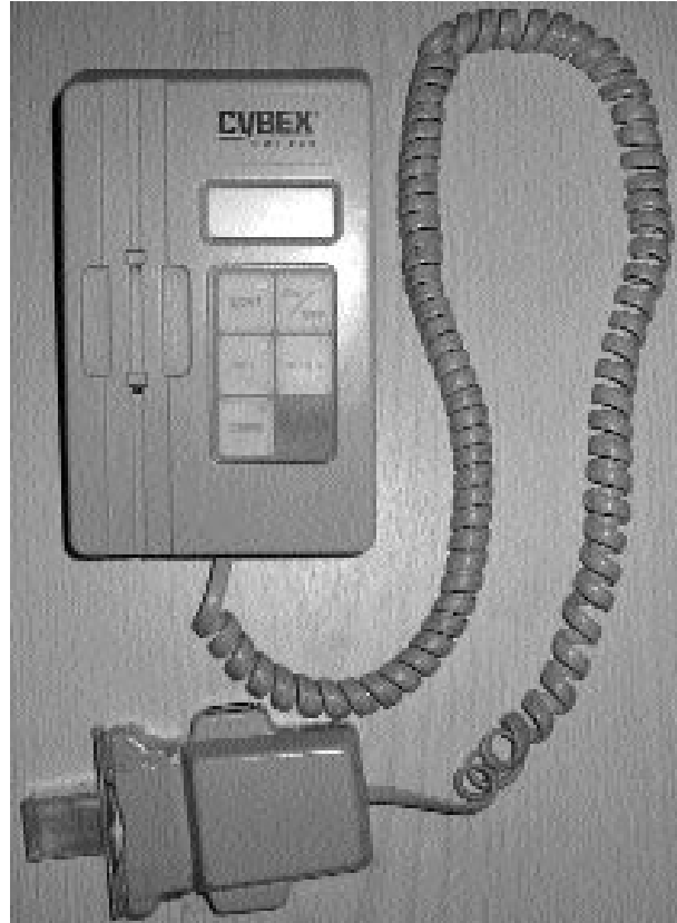
Şekil 1. Cybex elektronik dijital inklinometresi.
